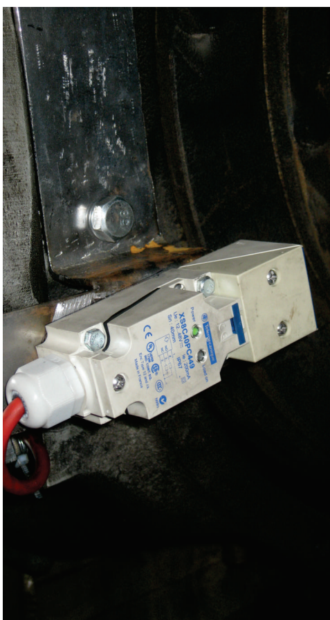
Senzor HALL pentru citirea turației direct pe volantă.
